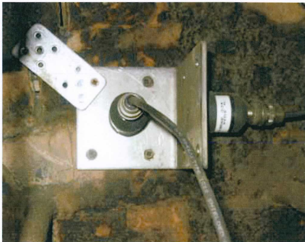
Fig. 5: Accelerometri monoassiali posizionati a quota +25.3 m.
